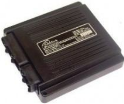
Перспективні системи керування двигуном корпорації Omnitek для природного газу і водню
