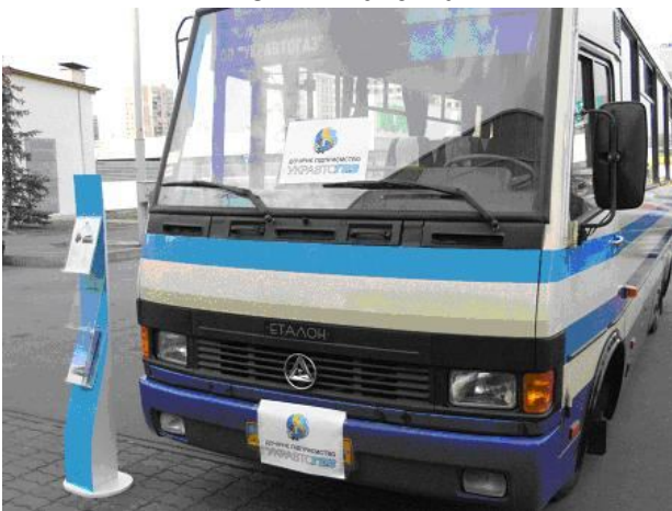
Автобус А079 «Еталон» Турист та його двигун переобладнаний для роботи на стисненому природному газі
